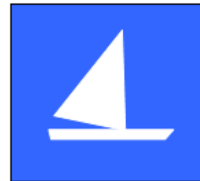
Hình 88: Báo hiệu báo khu vực tàu thuyền chạy buồm được phép đi lại (C4.19)
