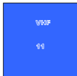
Hình 92: Báo hiệu báo tần số liên lạc để được trả lời những thông tin cần thiết cho việc tàu chạy (C4.23)
