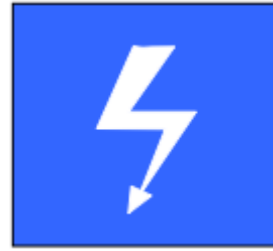
Hình 67: Báo hiệu phía trước có đường dây điện qua sông (C4.1)
